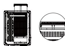
Stellen Sie den Filter so ein, dass die seitlichen Lamellen von den Löchern auf beiden Seiten des Filters aus gesehen werden können, wie in der Abbildung mit dem Pfeil zur Wand dargestellt.
